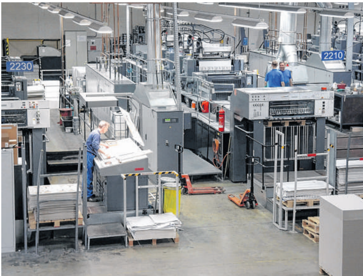
Hier wird gedruckt: Jeder Aufbau an den Maschinen bringt eine andere Farbe auf den Karton auf.
